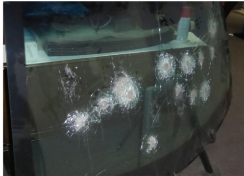
test de tir de pare-brise
